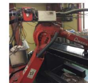
▲円筒部のレーザー溶接
