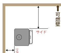
可燃壁面からの最低離隔距離は、上図のように設置した場合の距離です。
