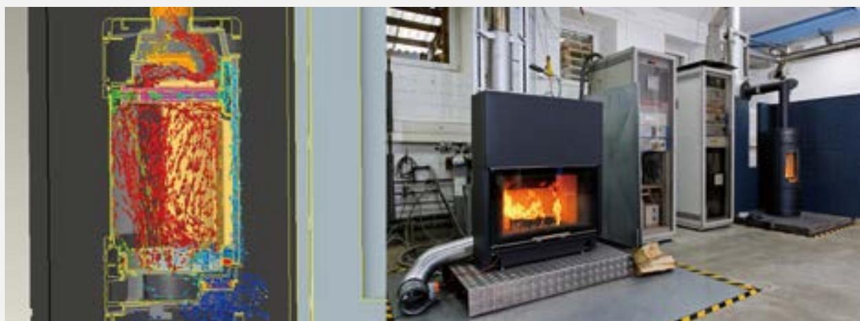
LEDAでは最先端の測定機器によりストーブに取り入れた空気が排出されるまでの“温度”、“量”、“流れ”、“滞留時間”などを細かく調べあげ理想的な空気の流れを生み出すための経路、炉内の大きさや形状を求めてきました。
